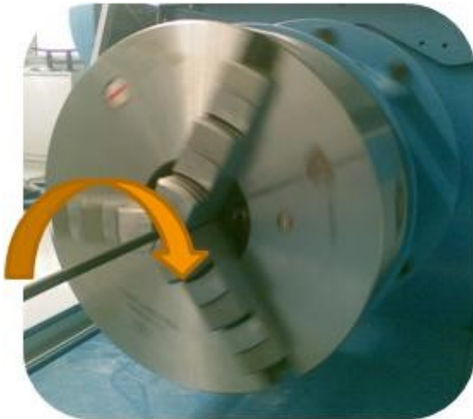
Fig: Torsion cycles: 50N \pm 135° 100°/s
