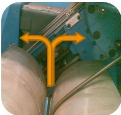
Fig: Reverse bending: 100N \pm 45° 160°/s
